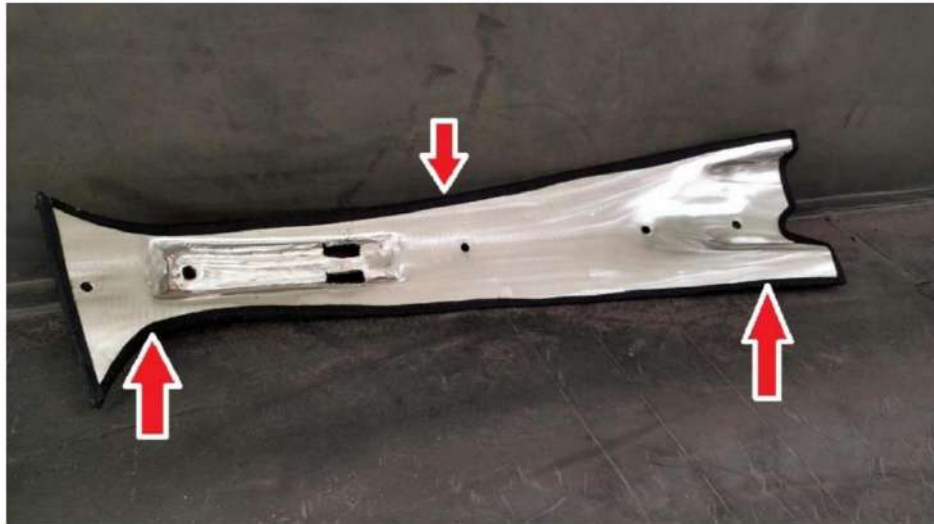
Detalhe da aplicação da fita feltro nas bordas das chapas de aço.
