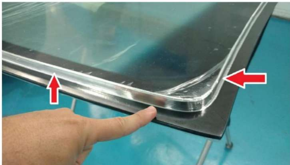
Fita de alumínio aplicada à lateral do pacote de forma a evitar a contaminação das lâminas.
