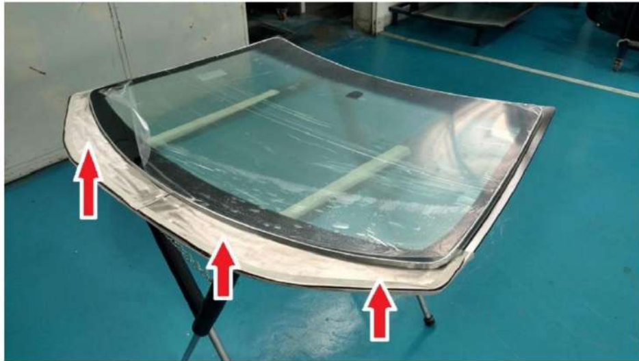
Reforço em aço inox na região do offset (sorriso) do para-brisa.
