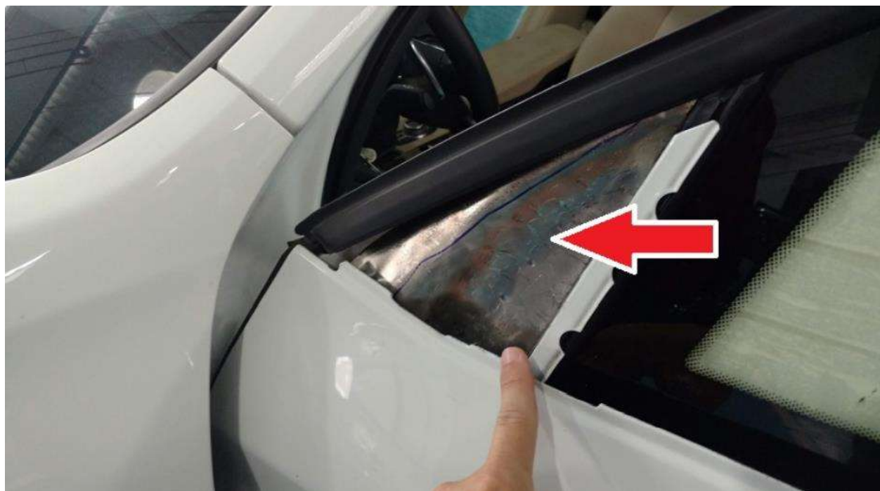
Chapa de aço inox aplicada na região do retrovisor externo
