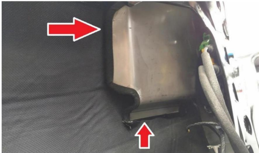
Detalhe do reforço em chapa de aço inox na região da maçaneta
