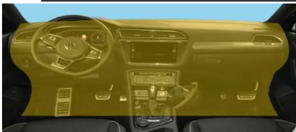
Painel corta fogo
