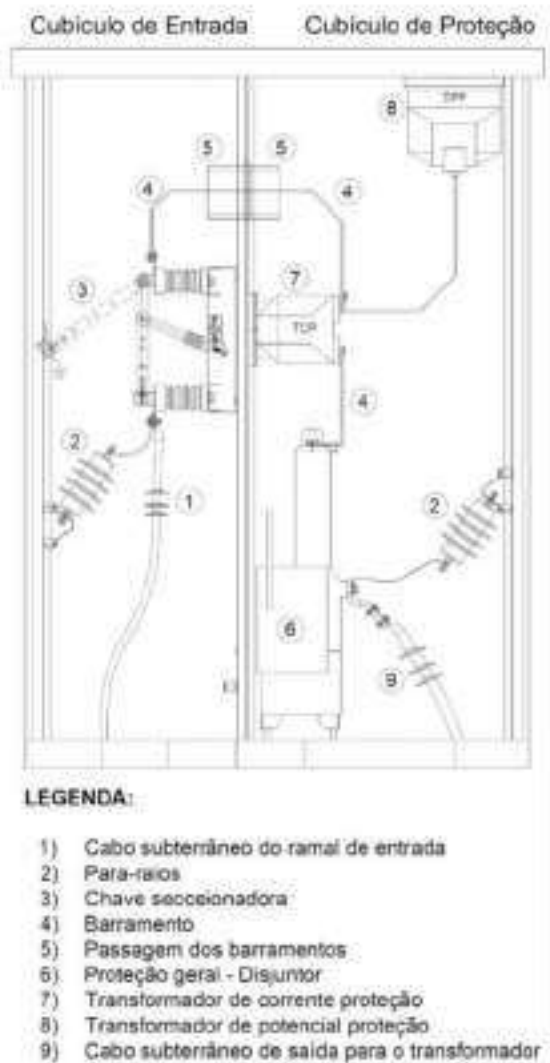
Figura 04 - Conjunto Blindado 15kV
