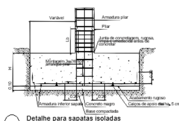
Detalhe para sapatas isoladas ESCALA 1:30
